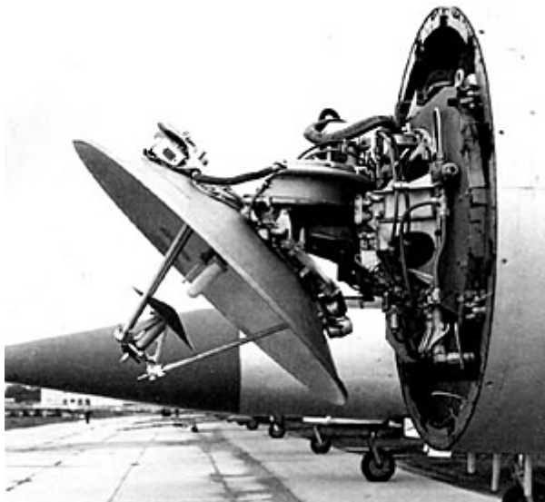
RP-11 Oryol-D58 típusú radar a repülőgép orrkúpjában, forrás: aerospace.boopidoo.com
